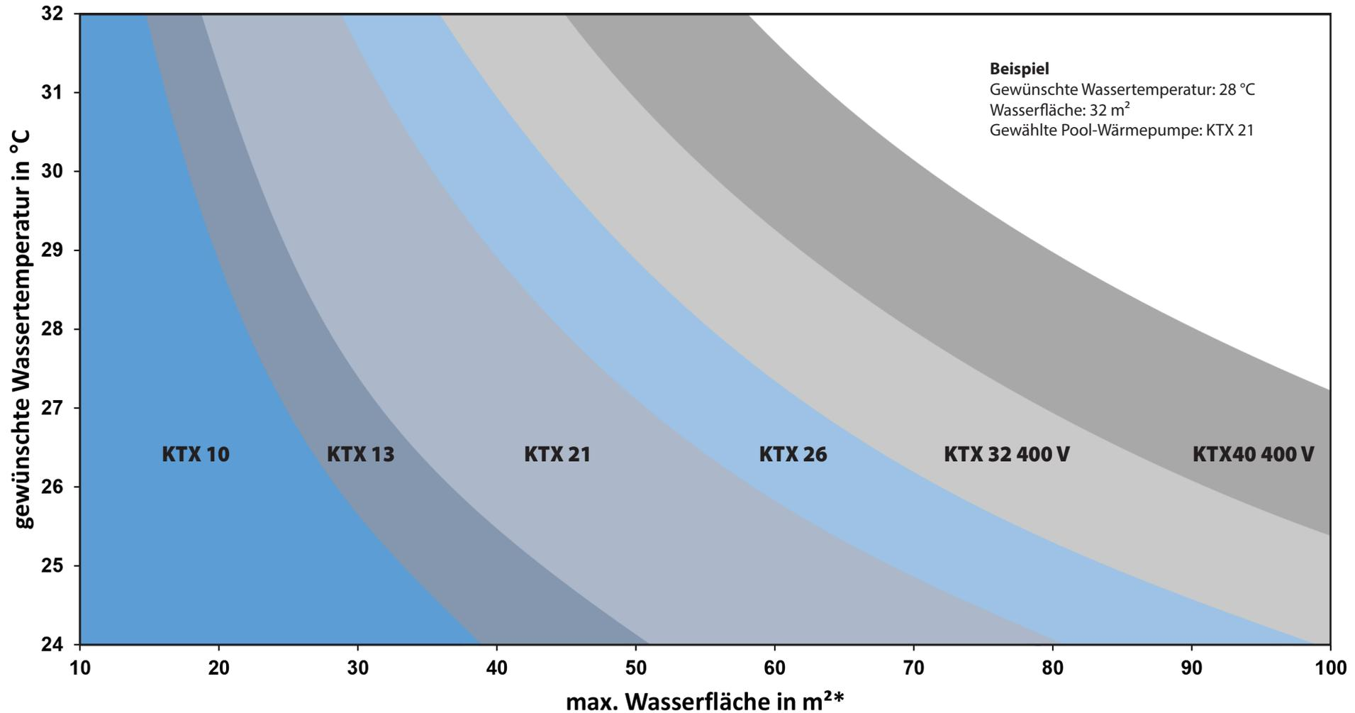
\* Das Diagramm beruht auf folgenden Parametern: Beckenabdeckung vorhanden; Klimazone Würzburg; windgeschützte Lage (max. 1 m/s); freiliegende Rohrleitungslänge < 6 m (max. 20 m Gesamtlänge); isoliertes und eingelassenes Becken ohne erhöhten Grundwasserspiegel; Heizbetrieb bis zu 16 Std./Tag.
