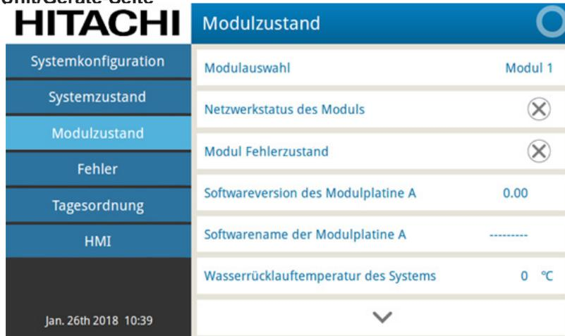
Die „Unit“-Seite erlaubt die Kontrolle der Betriebsparameter der einzelnen Geräte (modulare Systeme). Die folgenden Status-, Temperatur-, Druckwerte usw. können überprüft werden:
