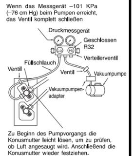
Zu Beginn des Pumpvorgangs die Konusmutter leicht lösen, um zu prüfen, ob Luft angesaugt wird. Anschließend die Konusmutter wieder festziehen.
