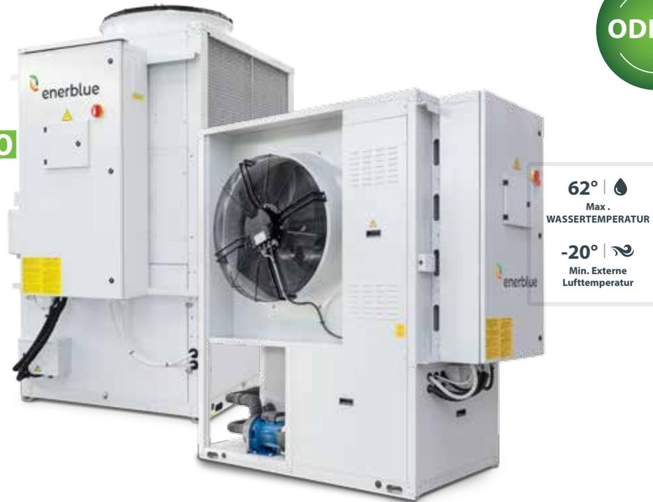
Luft-Wasser-Wärmepumpen mit natürlichem Kältemittel R290. Erweiterte Arbeitsbedingungen und sehr hohe Leistungen. Ausgestattet mit halbhermetischen Hubkolbenverdichtern, Axiallüfter mit Phasenschnittfrequenzregelung, Plattenwärmetauscher und Al/Cu-Minituben-Register. Die Verdichter verfügen über Invertertechnologie. Bei zwei Kompressoreinheiten wird ein Kompressor über einen Inverter angetrieben und ein Kompressor ist ein-/ausgeschaltet.
