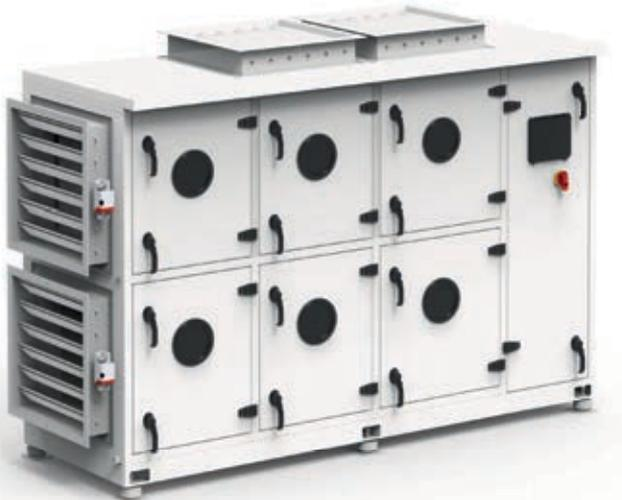
Die Geräte der **Serie H** sind in der Standardkonfiguration komplett mit allen Regelkomponenten (Systeme für Wärmerückgewinnung, Kühlung, Vor- und Nachheizen, Be- und Entfeuchtung) für die Aufbereitung der gesamten Außenluft oder mit Teilrückführung ausgelegt.
