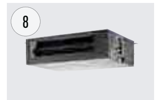
8 Kanalgeräte für kommerzielle Anwendungen Besonders leise Kanalgeräte für optimale Zuluftversorgung in Restaurants. Geräte ab 1,5 kW Leistung für eine präzise Temperaturregelung selbst in kleinen Räumen. Zwei verschiedene Modelle: superflache Kanalgeräte (MM) mit einer Höhe von nur 200 mm oder Kanalgeräte (ME) mit hoher statischer Pressung und Frischluftfunktion (bis 100 %).
