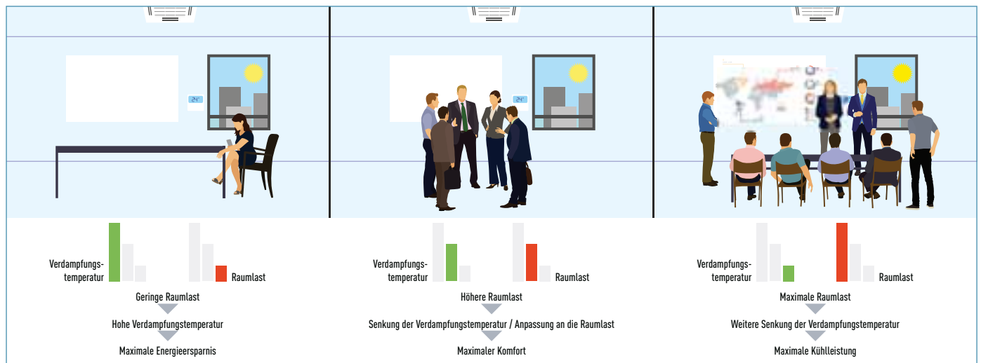
Lastabhängige, modulierende Regelung der Verdampfungstemperatur am Beispiel des Kühlbetriebs (für Heizbetrieb entsprechend)
