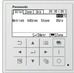
**2** Schalten Sie zur Anzeige zum Sperren von Fernbedienungsfunktionen.
