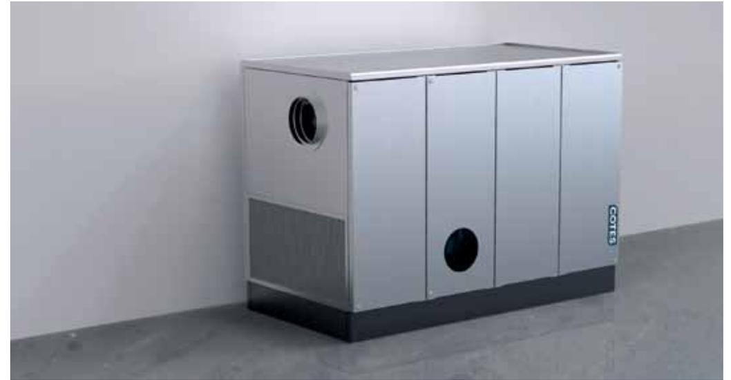
Wirksame Feuchtigkeitsregulierung mittels Adsorptionsentfeuchtern ist oft der wirtschaftlichste Weg der Entfeuchtung. Nicht zuletzt da die in der Luft enthaltene Wärme zur Senkung des Feuchtigkeitsgehaltes eingesetzt wird. Die Zufuhr von zusätzlicher Heizenergie außerhalb der Entfeuchtungsanlage fällt daher weg.
