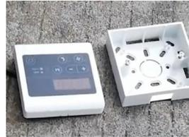
Die entsprechende Aussparung entfernen und die Rückseite der Box an der Wand anbringen.
