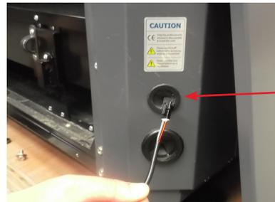
Die Leitung anschließen und den Schlauch wieder über die Anschlüsse schieben. Den Schlauch mit einem Kabelbinder sichern.
