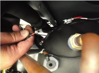
Das Kabel von der Fernsteuerung durch den oberen Kabelzugangspunkt führen.
