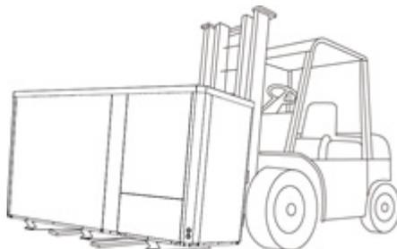
**Die Wärmepumpe nicht an den Wasserein- oder -auslassanschlüssen anheben.**
