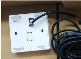
Die beiden Schrauben auf der Rückseite der Fernsteuerung entfernen.
