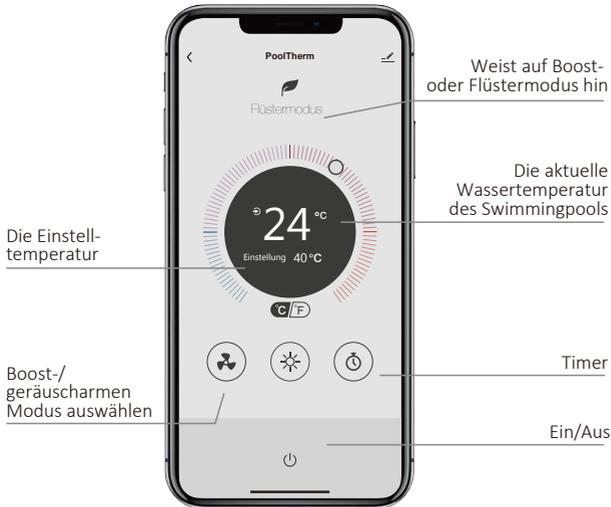
2. Für Wärmepumpen mit Heiz- und Kühlfunktion:
