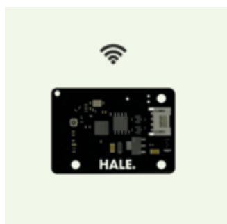
HA-CUK02 für HUM-45DWCE WiFi-Nachrüstung zur Einbindung in das Hale-Steuerungssystem zur drahtlosen Steuerung.
