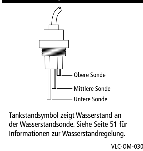
Abbildung 35-2: Wasserstandregelung für Normalwassersysteme
