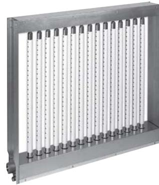
Das Hocheffizienz-Dampfverteilssystem XV reduziert mit seinen isolierten Dampfverleirerohren das Kondensat bis zu 67 (!) Prozent. Dadurch ist kein Kondensatablauf erforderlich. Die Nachverdampfung des Kondensats findet innerhalb des Dampfverteilsystems statt.
