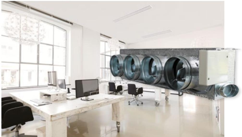
Öffnung der Klappen einstellen, um den Volumenstrom an jedem Auslass anzupassen. Zudem kann der maximale Schließungsgrad eingestellt werden, damit Zonen ohne Bedarfsanforderung nur minimale Luftmengen erhalten.
