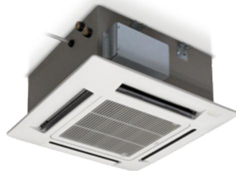
Der Anwender kann zwischen direkter oder durch Mischung mit der Umluft erfolgten Frischluftzufuhr wählen. Für beide Fälle gibt es passende Anschlussstücke. Die Luftverteilung kann dann über vier verstellbare wärmegeämmte Luftleitlamellen gesteuert werden. ■
