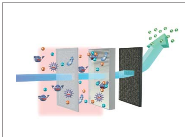
Anti-Odour (vermeidet schlechte Gerüche) und Blütenstaubfilter
