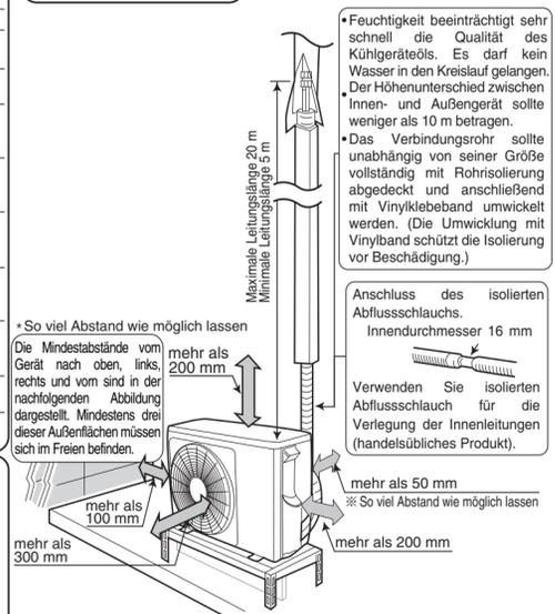
Bei der Installation des Außengeräts muss an mindestens zwei Seiten des Geräts ausreichend Raum für die gute Luftzirkulation bleiben.
