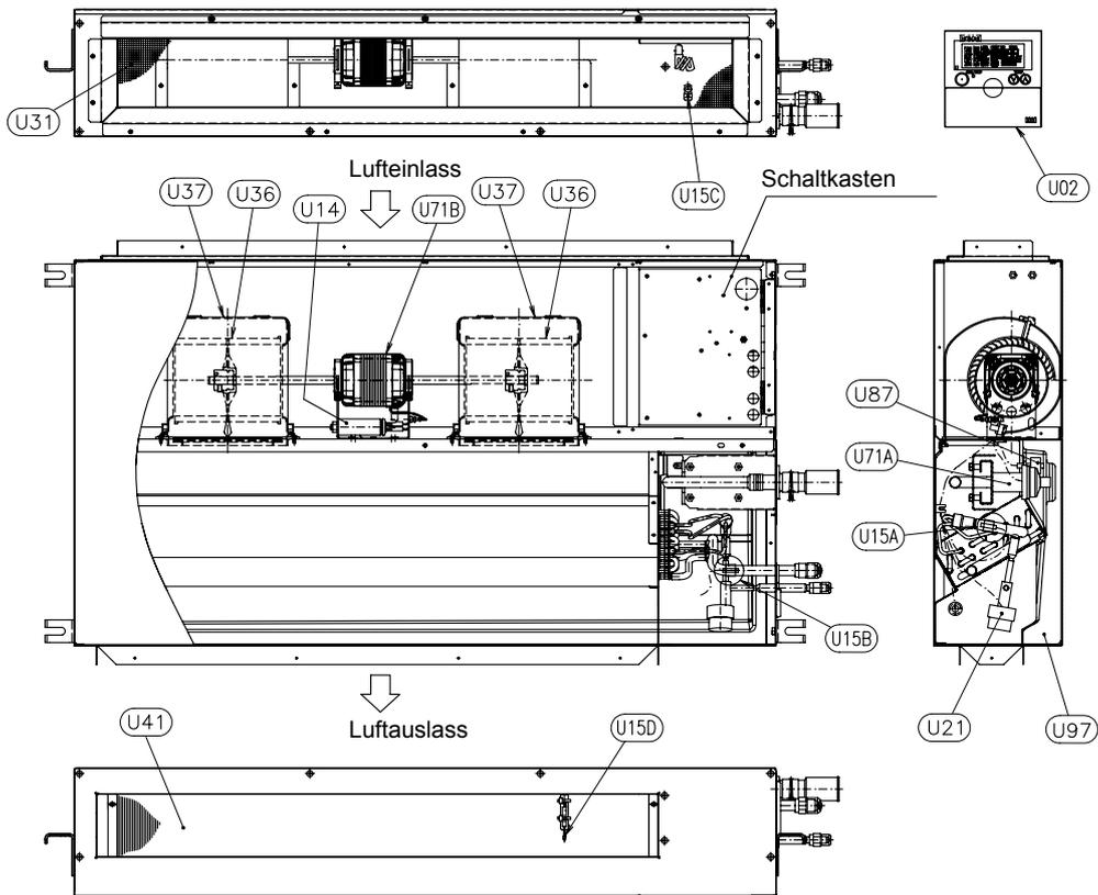
Position der elektrischen Bauteile
